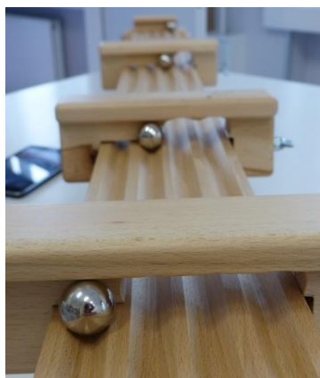
18. ábra Egyenletesen változó mozgás vizsgálata Galilei lejtővel
