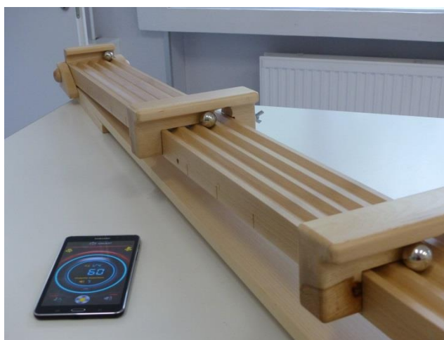
19. ábra Egyenletesen változó mozgás vizsgálata Galilei lejtővel
