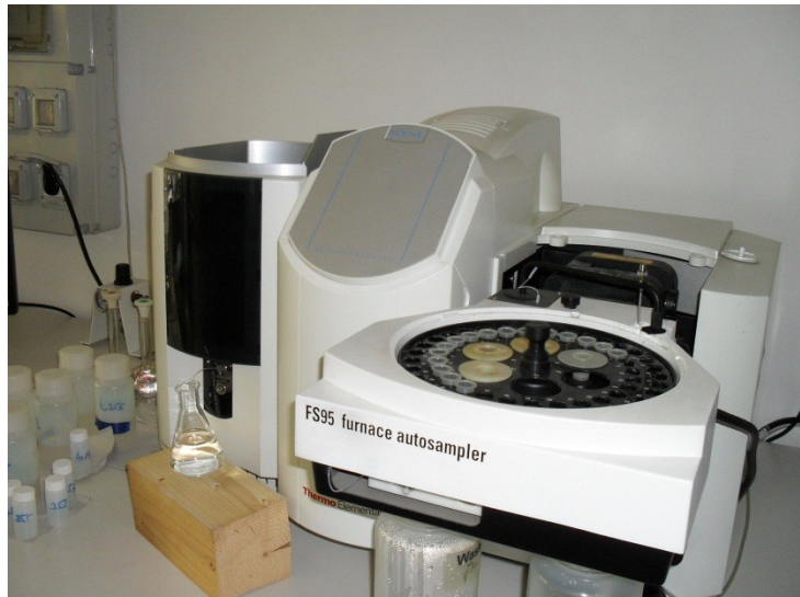
2. ábra. Az általunk használt atomabszorpciós készülék, az ábra bal oldalán látható a láng oldal, míg a grafitkemencés oldal a jobb oldalon egy autosampler egységgel kiegészítve.
